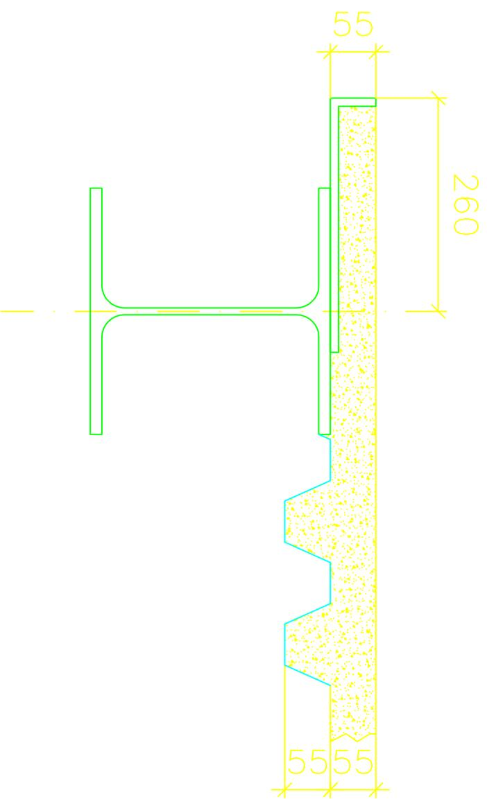
SEZIONE SOLAIO (filo esterno)
